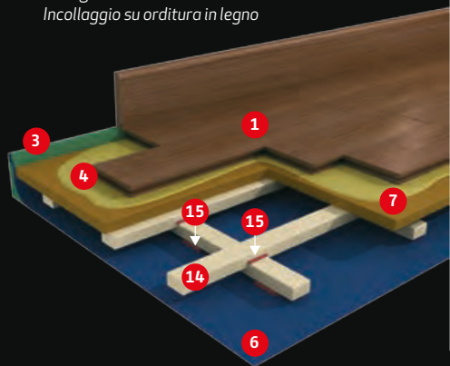
Gluing on wooden framework Incollaggio su orditura in legno
