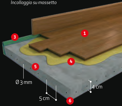
Gluing on concrete Incollaggio su massetto
