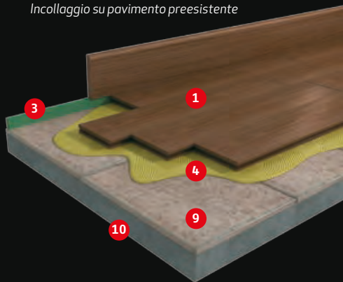
Gluing on existing floor Incollaggio su pavimento preesistente
