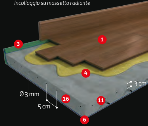
Gluing on radiant concrete Incollaggio su massetto radiante
